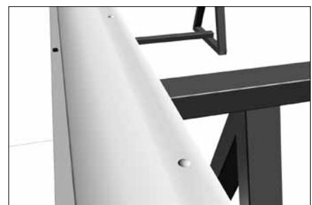
Установите боковые крышки на профиль карниза ролика направляющего. Закрепите крышки при помощи заклепок.
