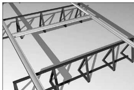
Возьмите боковой основной несущий профиль (2) и состыкуйте его с профилем для сборки панелей (5). Скрепите их между собой с помощью заклепок (17), предварительно просверлив отверстия сверлом Ø4,2 мм. Расстояние между отверстиями должно быть 100 мм. Длястыковки профилей вставьте угловые соединения щита (8).
