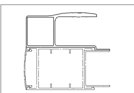
Установите профиль карниз ролика направляющего на верхний несущий профиль ворот, таким образом что бы выборка профиля карниза ролика направляющего встала на профиль для сборки панелей.
