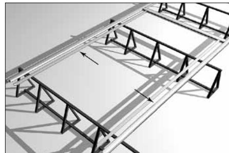
Проверьте точностьстыковки углов профилей и отсутствие зазоров между соединениями. Прикрепите профили для сборки панелей (5) к верхнему и нижнему несущему профилям (2) с помощью заклепок (17). Расстояние между точками крепления — 100 мм.
