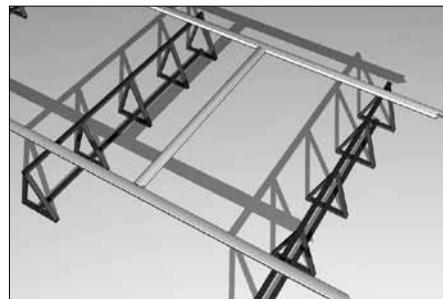
Сборку полотна сдвижных ворот необходимо производить на ровной горизонтальной поверхности. Это могут быть стол или стапели. Возьмите верхний и нижний основной несущий профили (2) — два длинных профиля и положите их на стапели.
