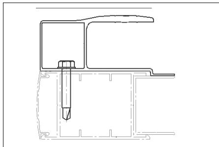
Закрепите профиль карниза ролика направляющего саморезами 5,5×32 мм со сверлом к основному несущему профилю.
