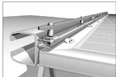
Распределите зубчатые рейки (21) по всей длине полотна ворот вплотную друг к другу. Прикрепите к рейкам стандартный крепежный комплект (22) и установите рейки на С-профиль с помощью болтов M8×25ПГ (25), закладных пластин (24) и скоб универсальных (23).
