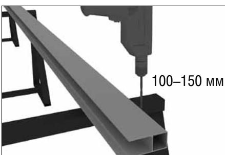
Возьмите профиль карниз ролика направляющего (7), отметьте места под отверстия в лицевой стенке профиля по всей длине профиля, сверлом Ø13,5, с отступом от края 100–150 мм. Проделайте отверстия с шагом не более 300 мм.
