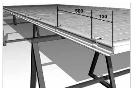
Разместите на нижней части щита стальные оцинкованные кронштейны крепления щита к балке (7). Расстояние от края балки (1) до кронштейна должно составлять 130 мм. Между кронштейнами — 500 мм.
