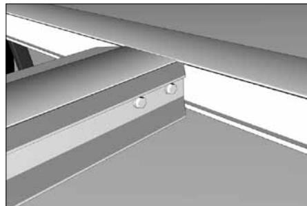
Просверлите отверстия сверлом Ø15 мм в верхнем и нижнем несущих профилях.
