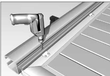
Закрепите С-профиль (26) при помощи саморезов (19), предварительно просверлив отверстия сверлом Ø4,2 мм.
