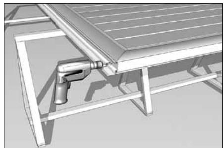
Просверлите отверстия сверлом Ø4,2 мм.
