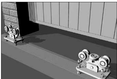
Закрепите опоры (11) с помощью гаек M16.
