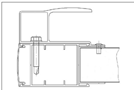
Закрепите профиль карниза ролика направляющего к профилю для сборки панелей заклепками (12) с шагом 300 мм.
