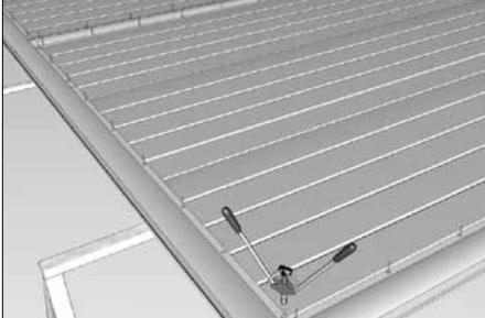
Плотно состыкуйте панели между собой и вставьте боковые профили. Скрепите панели с профилами для сборки панелей заклепками (17) с шагом 200 мм. Крепление осуществляется с внешней и внутренней стороны щита.
